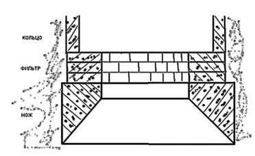
ках «ножа», удобно выбирать грунт, ноги не вязнут. Особенно легко с его помощью проходить жидкие глины и мокрый песок. В процессе работы мокрый грунт попадает в конус, становится плотным и сдерживает воду. Попадая в водоносный слой, конус уплотняет песок, делает плотную песчаную пробку и не даёт песку подниматься выше конуса.
