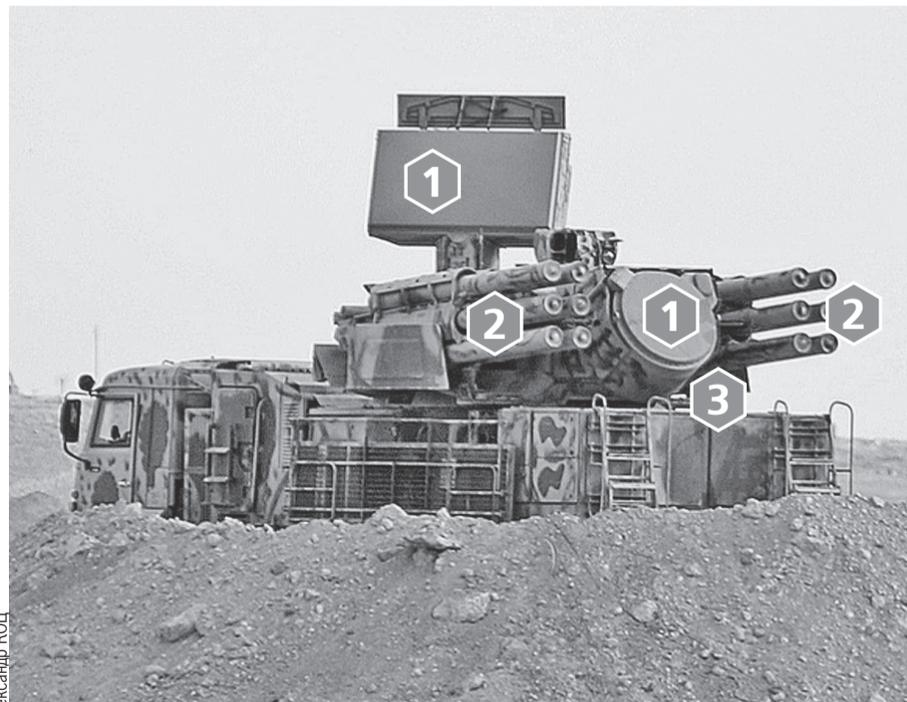
Спецкору «Комсомолки» удалось заснять комплекс «Панцирь» на боевом дежурстве под Дамаском. Его козырь - двойной радар ❶ и поражение целей не только ракетами ❷, но и автоматической спаренной пушкой ❸ с бронебойно-зажигательными снарядами (в нерабочем состоянии не видна).
